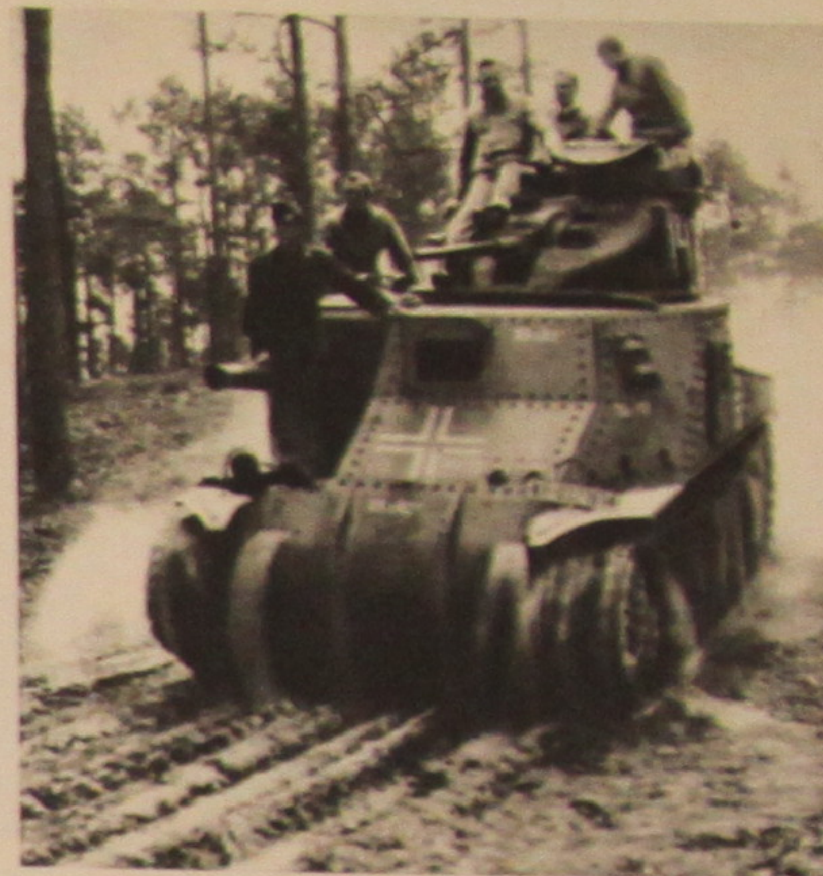
Ein Amerikaner vom Typ „General Lee“ in der Erprobung. Dieses ist eine ältere Konstruktion der Vereinigten Staaten mit gegossener Kuppel und aus Panzerplatten genietetem Rumpf. Es handelt sich hier um eine bereits überholte Konstruktion. Das Beutestück stammt vom östlichen Kriegsschauplatz.
