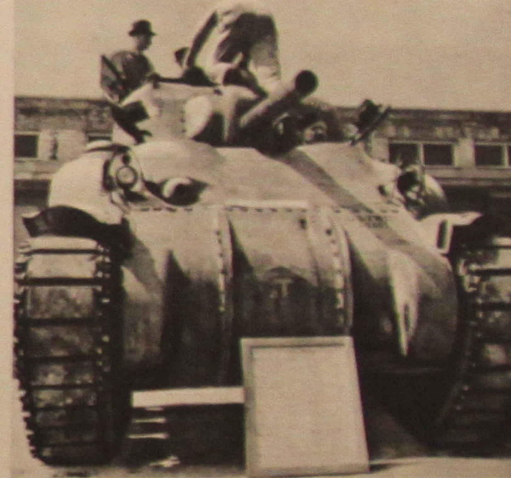
Ein amerikanischer „General Sherman“ auf dem Versuchstand. Im Vordergrund eine Typentafel mit den ermittelten Daten. Die Beschriftung auf dem Panzer zeigt die festgestellten Wandstärken des Panzers. Der „General Sherman“ ist aus dem „General Lee“ entwickelt. Die Seitenkanone ist in Fortfall gekommen, der gesamte Rumpf ist aus Gußstücken zusammengesetzt. Hierdurch hat der „General Sherman“ sein besonderes Gesicht bekommen.
