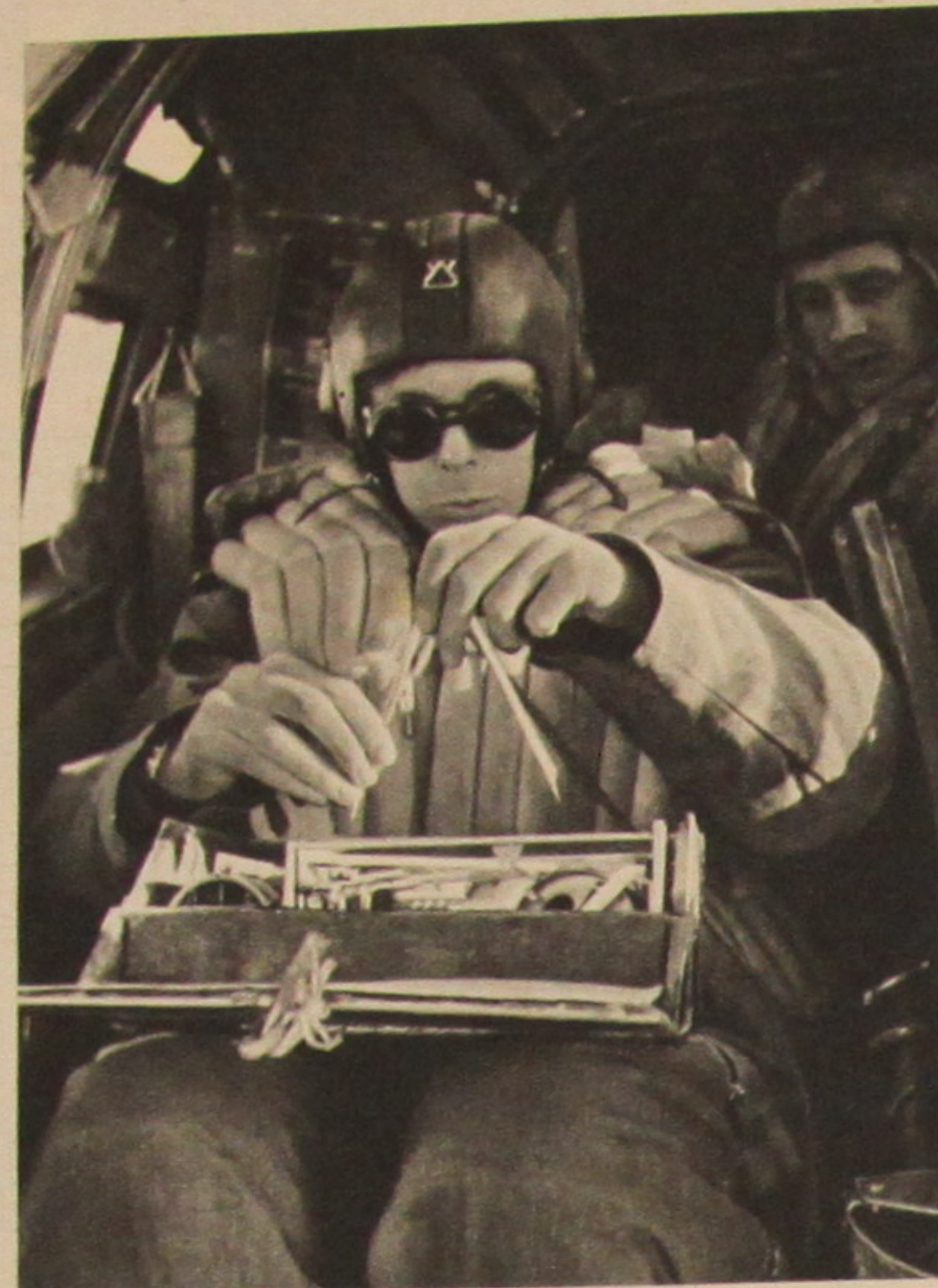
Bei dem Höhenflug hat ein automatisches Gerät, der Meteorograph, das Steigen und Fallen von Luftdruck, Temperatur und Feuchtigkeit in drei nebeneinander liegenden Kurven aufgezeichnet und so dem Meteorologen einen Querschnitt durch die Wetterlage in dem durchflogenen Höhengebiet vermittelt. Der Meteorologe greift mit dem Zirkel die Kurven ab und rechnet sie um, die Werte werden an die Wetterwarte gefunkt.
