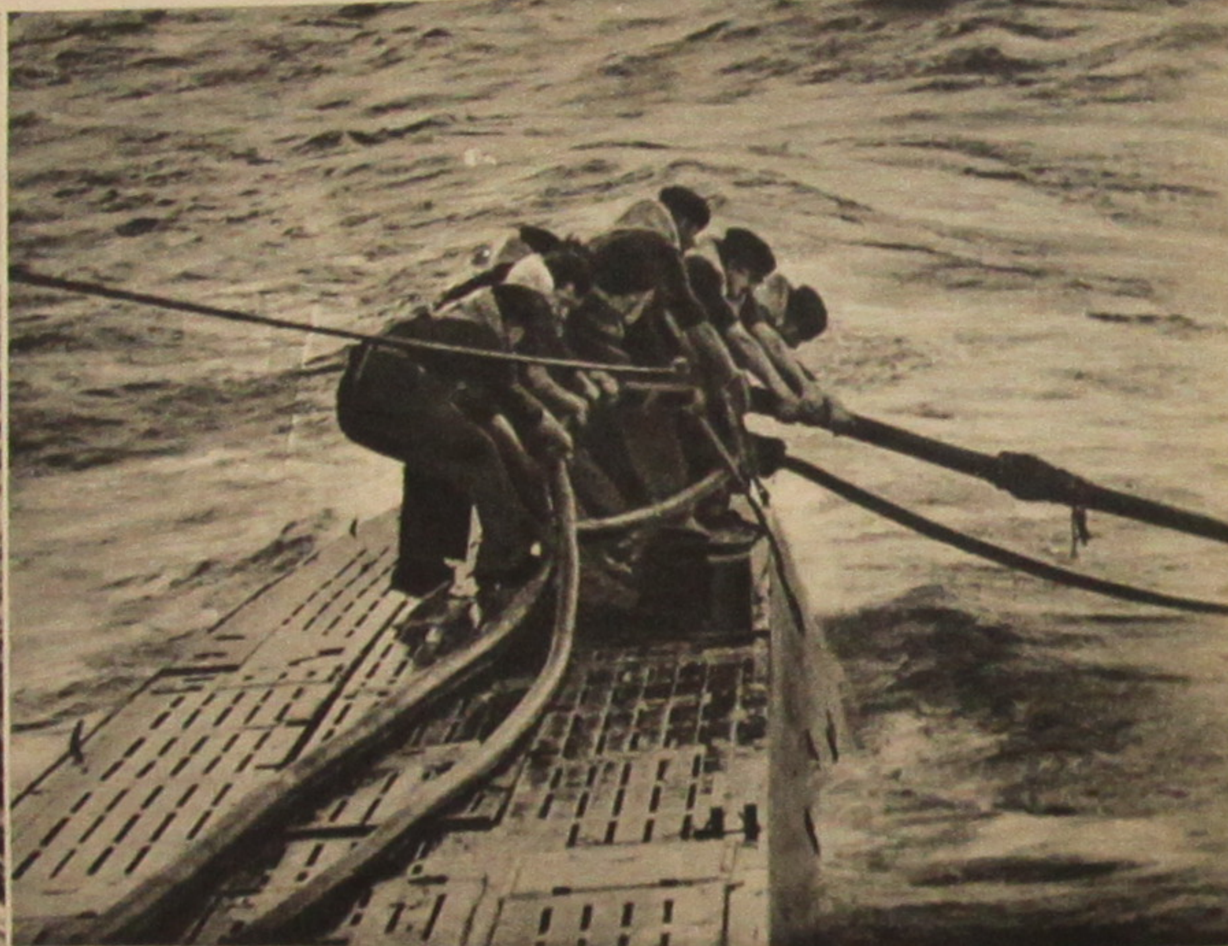
Die Schläuche, durch die das Dieselöl gepumpt wird, sind mittels Leinen herübergezogen und werden angeschlossen. Die Versorgung bezieht sich nicht nur auf Brennstoff, sondern auch Proviant aller Art wird an Bord genommen
