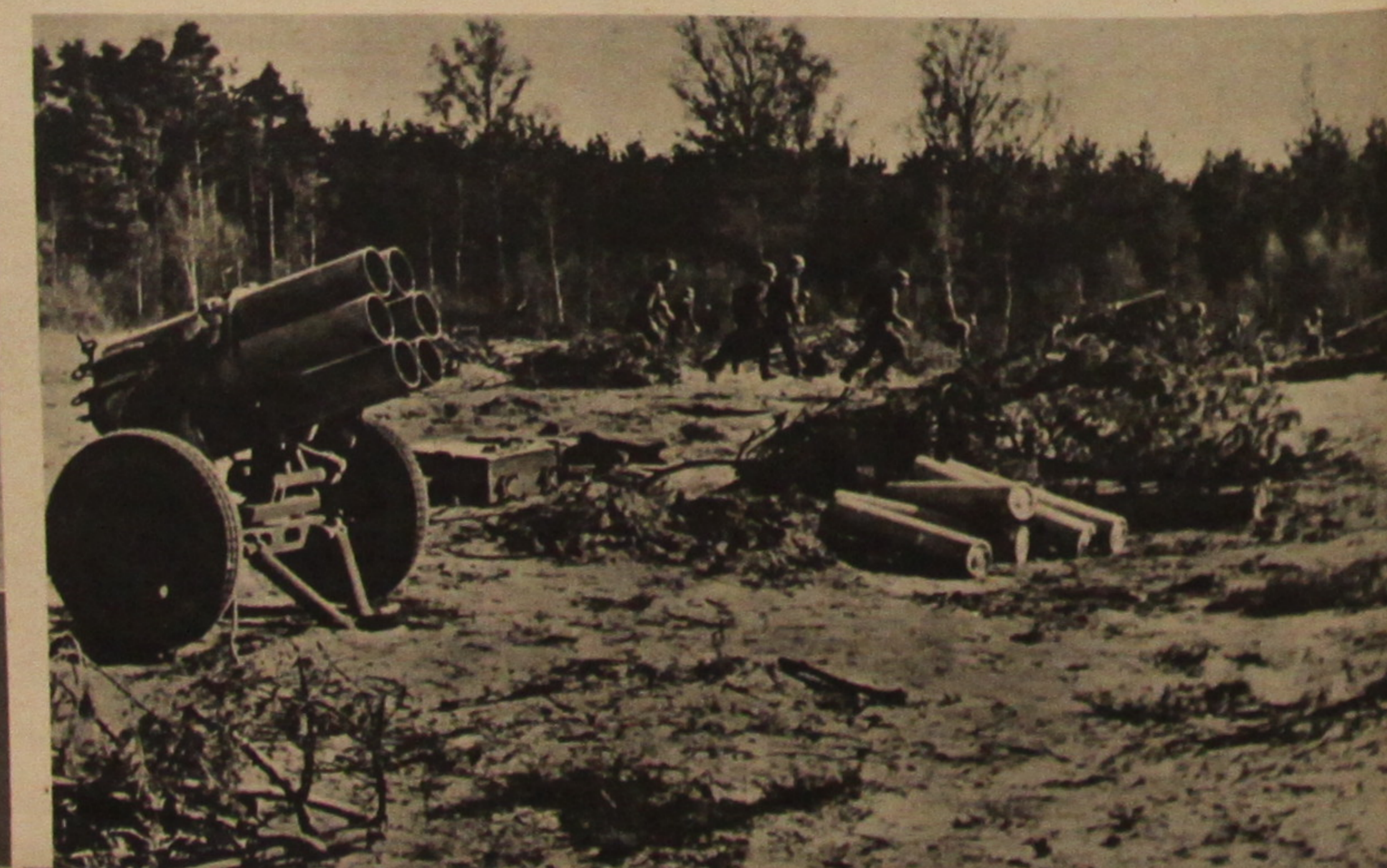
Die Geschosse werden elektrisch entzündet. Etwa zehn bis fünfzehn Meter seitlich hinter dem Werfer sind mannstiefe Gruben ausgegraben worden, in denen sich die Kanoniere beim Abschluß der Salven aufhalten
